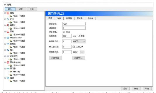
目前软件支持绝大多数主流品牌的 PLC, 你可以根据需要选择对应的品牌, 左侧设备树上, 我们选择西门子, 并点击"添加一个通道"按钮, 在随后的弹出菜单里选择 \$7-1200, 就可以生成一个新的通道:
